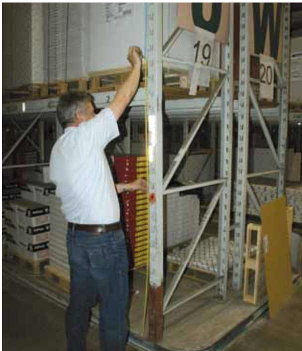
Abb. 6: Überprüfung der Fachhöhe
