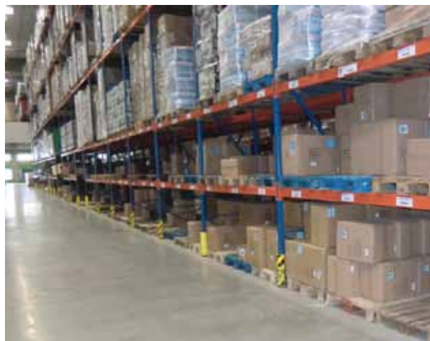
Abb. 19: Stützenschutz an allen Stützen
