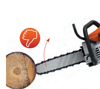
Rückschlaggefahr im Bereich der oberen Schwertschulter
