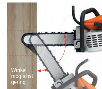
Bei Stechschnitten Säge unter flachem Winkel zur Werkstückoberfläche ansetzen. Beim Einstechen ständig Druck auf den unteren Teil der Sägekette ausüben.
