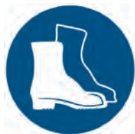
Sicherheitsschuhe in der Werkstatt und auf Baustellen (S3)
