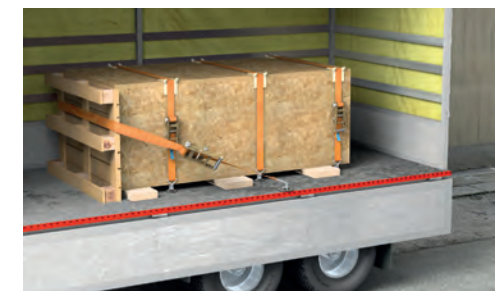
Kombinierte Ladungssicherung am LKW
