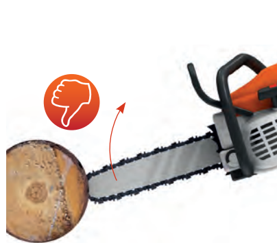
Rückschlaggefahr im Bereich der oberen Schwertspitze
