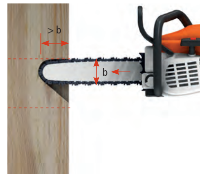
Erst wenn die Schienenspitze mehr als das Maß der Schienenbreite eingetaucht ist, Stechschnitt vollständig durchführen.
