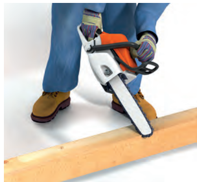
Abgeschrägte Schwertspitze vermindert Rückschlaggefahr
