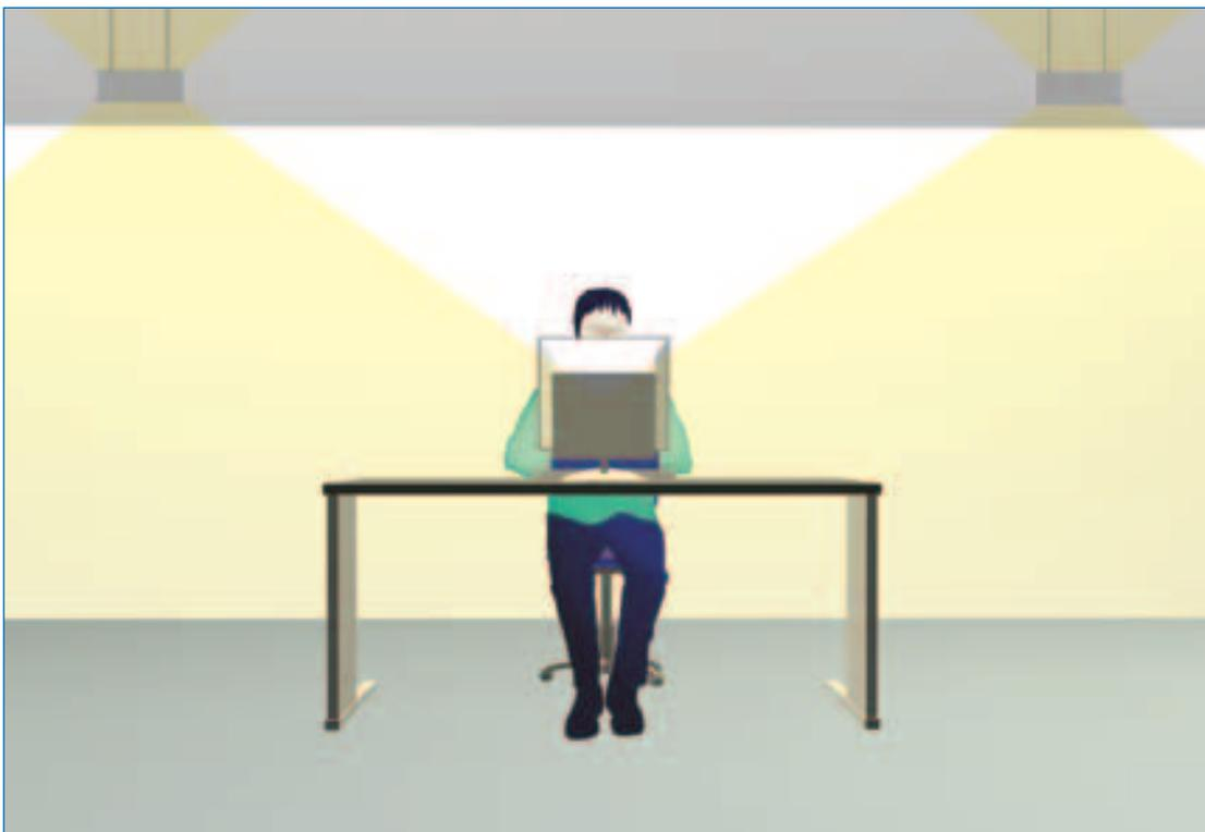
Abbildung 4.3.3-1 Beispiel für Direkt-/Indirektbeleuchtung
