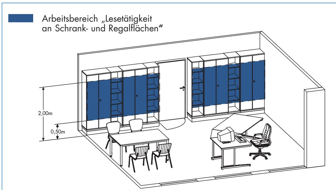
Abbildung 4.2.3-1b Teilflächenbezogene Beleuchtung: Bewertungsflächen die für vertikale Beleuchtungsstärke ( $\bar{E}_v$ )
